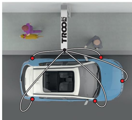
En version standard, le concept de déploiement du câble VE, convient parfaitement à un large trottoir et une voiture de grande dimension.
